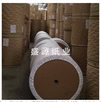
裝饰原纸:克重范围70□110g/m2□亦称"三聚氰胺浸渍纸、钛白纸",遮盖力、耐候性(色牢度)较好,原纸经印刷、浸胶后用于强化木地板、办公家具压板等。三聚氰胺浸渍胶膜纸:特点:可用于刨花板、中密度纤维板,或硬质纤维板等基材的贴面。并且有自然的装饰效果和耐损、耐酸碱、耐划痕、耐腐蚀、易清洗等优点。防护:在相对湿度55%65%,温度1030℃和条件下密封贮存。耐磨纸耐磨纸是一种添加了三氧化二铝的浸渍三聚氰胺的贴面纸。耐磨纸使强化复合地板表层光亮,耐磨损。其有高透明、耐磨损、无瑕疵、防火、保养方便等特点。耐磨纸有18克,22克,45克等几种,按照生产工艺的不同,耐磨系数也不同。目前耐磨纸应用在强化木地板比较多。好的耐磨纸可以承受6000转的测试。家具板目前还没有大量使用。
